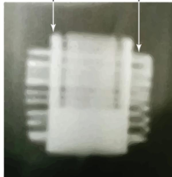
En una placa realizada correctamente, el dispositivo se verá así. Cuando el dispositivo está desactivado, el resorte se ve como se muestra en la imagen.
